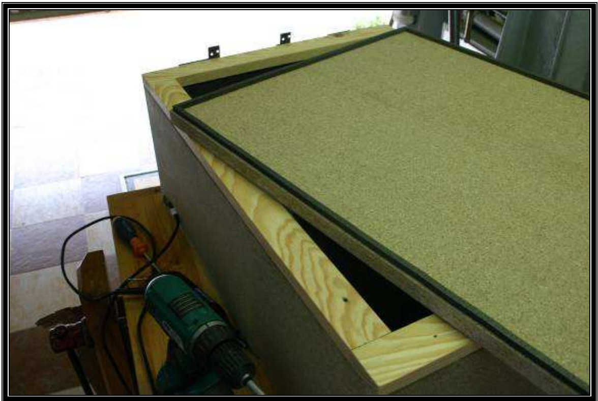
1/1567- Cinta de esponja en la tapa porta-molde para mejor cierre del vacío.
