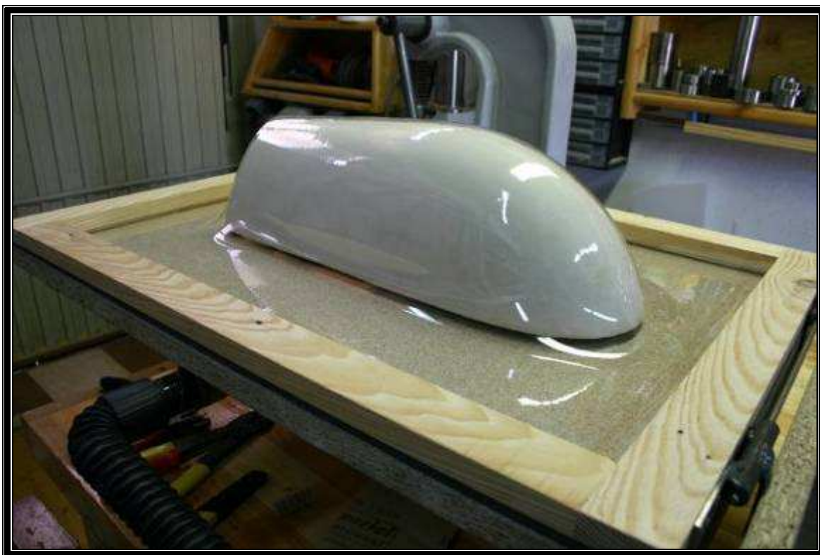
7/1474-Primera cabina realizada en esta caja de vacío.
