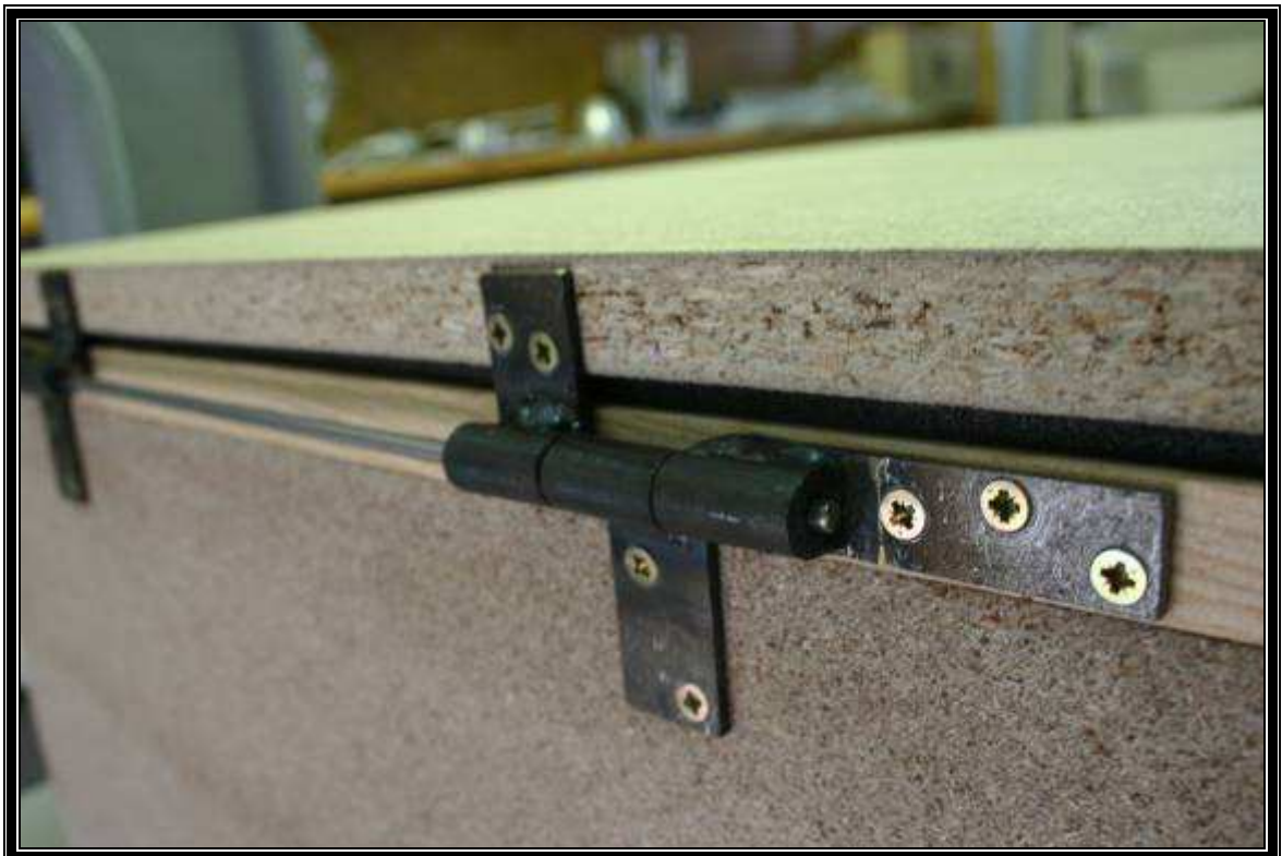
2/1568- Bisagra especial para que giren sobre el mismo punto el marco y la tapa porta-molde.
