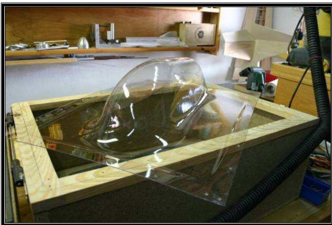
8/1475-Cabina fuera del molde.
