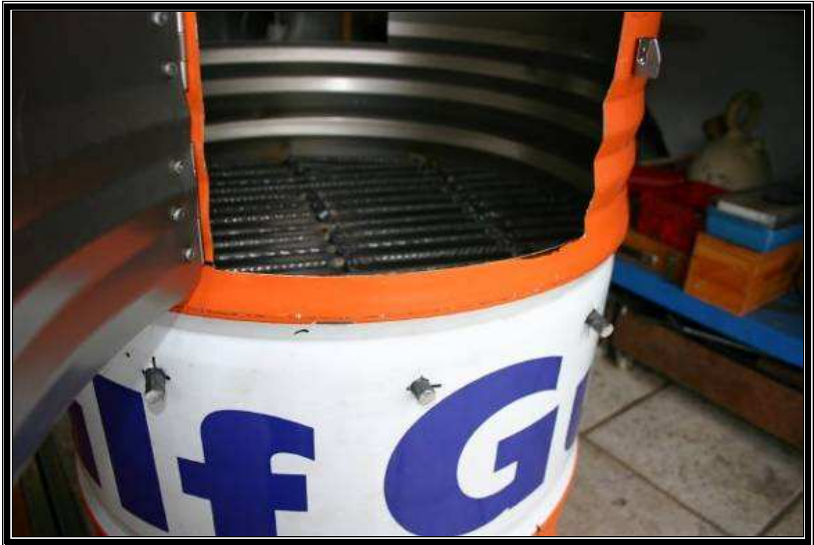
8/1487-Detalle de las tres barras que atraviesan el bidón.
