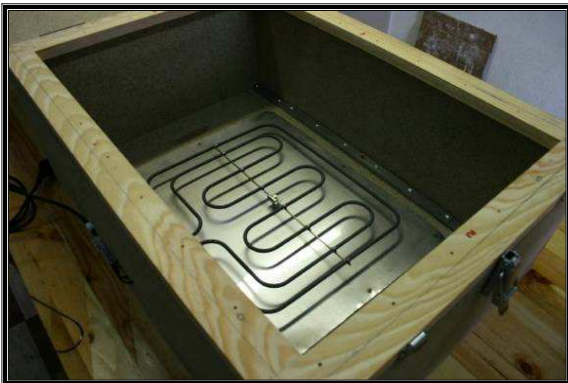
6/1479- Una resistencia de 2500 w. colocada a cierta distancia de la chapa.
