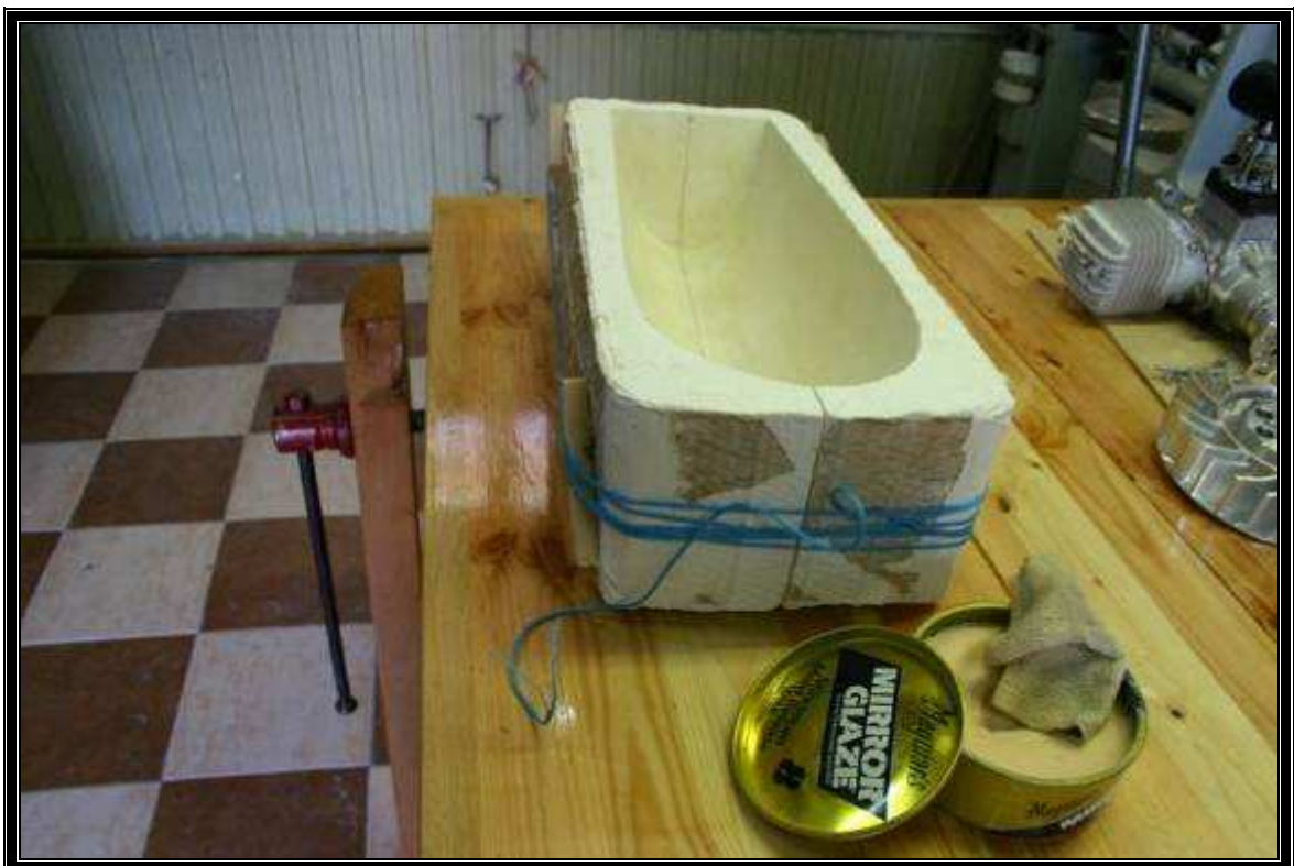
13- Encerar, secar y listo para echar la escayola que moldeará la cabina.
