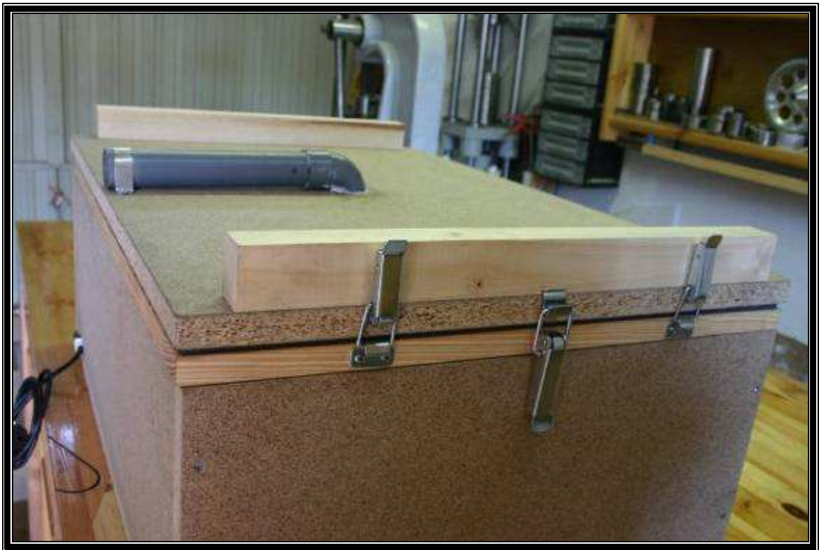
3/1470-detalle de cierres de caja marco y tapa. Tubo de vacío colocado también en la tapa. (Silicona).
