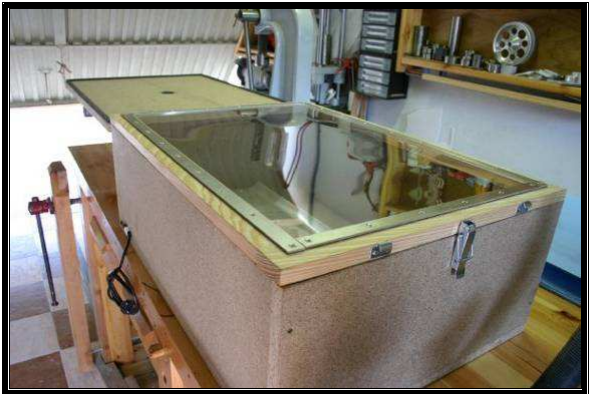
4/1471- El plástico termo-deformable amarrado en el marco.
